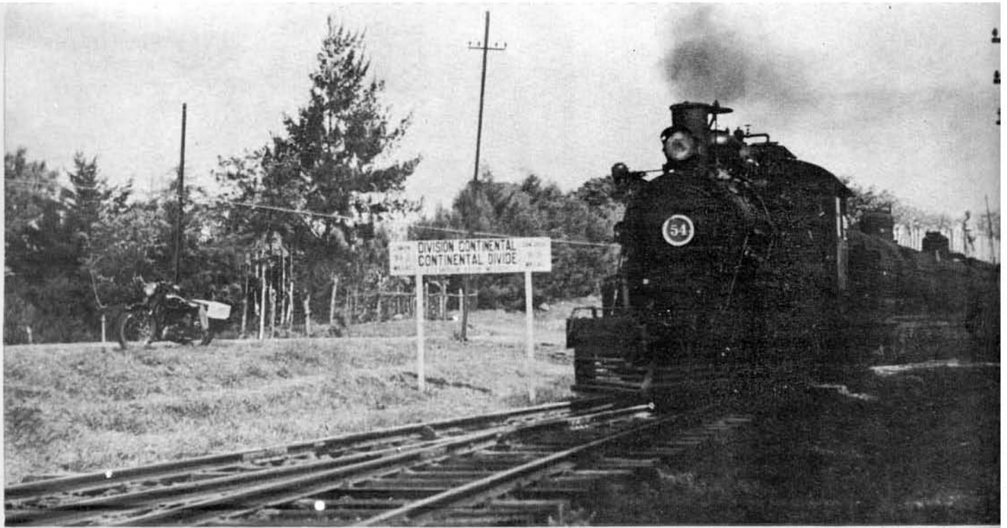
La locomotora No. 54, halando un tren a través de la División Continental en El Alto (Milla 93.2) La elevación de la línea aquí es de 1549 metros (5084 pies) y desde Peralta a El Alto, una distancia de 38 millas, un tren tiene que subir 1193 metros (3914 pies) lo cual resulta en un promedio de gradiente de 1.95%. La máxima gradiente en esta sección (El Alto--Peralta) es casi 5% en Milla 92¼.
