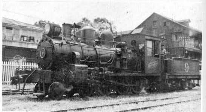
Locomotora No. 9. Una de las tres (7 - 9) switcheras en servicio en Limón. Construída en 1890 por Neilson & Co., Escocia; pesa 124,000 y tiene 48 pies de largo. Esfuerzo de tracción: 13,300 libras.
