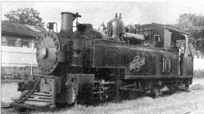
Locomotora No. 10. Una máquina switchera de tanque, casi siempre en servicio en el patio de San José. Fué construída en 1900 por Nasymth Wilson Co., Inglaterra; pesa 93,000 libras y tiene 32 pies de largo. Esfuerzo de tracción: 19,500 libras.
