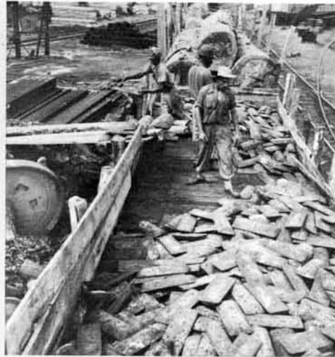
Para fundición de calidad solamente se usan lingotes de hierro virgen importados de los Estados Unidos.
