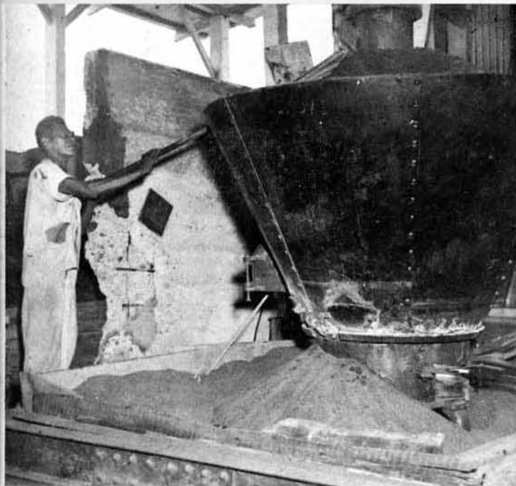
Secador de arena diesel. Arena se usa para evitar que las locomotoras resbalen, y también para los tubos de caldera.
