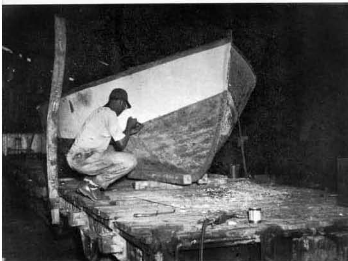
Lancha del piloto en el proceso de limpieza antes de ser reparado el casco por medio de soldadura eléctrica.
