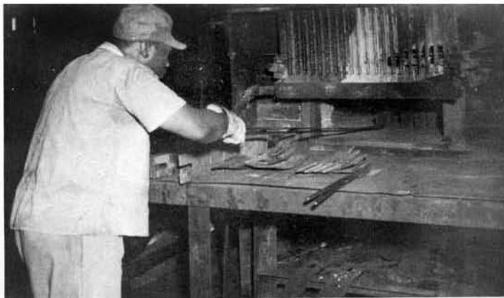
Horno quemador de petróleo con control de pirómetro para calentar resortes de locomotora en el proceso de templado.
