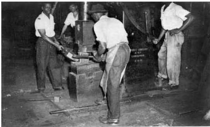
Vista de un martillo de potencia en la herrería. Esta sección de los Talleres de Limón emplea aproximadamente 20 hombres.
