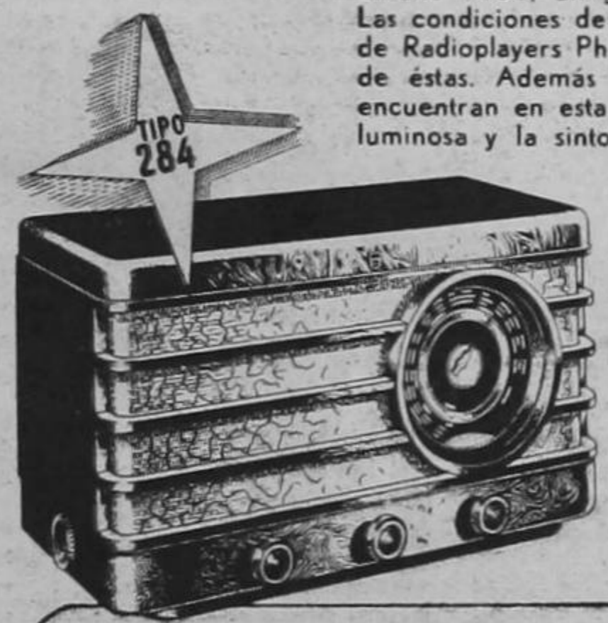
TIPO 284. - Superheterodino de 5 tubos equipado por primera vez con el tubo amplificador de radiofrecuencia Silentodo, tablero de mando "discosolar" y 3 gamas de onda desde 13.5 a 560 m. Construcción a prueba de los trópicos y bonito mueble de "Philite".
