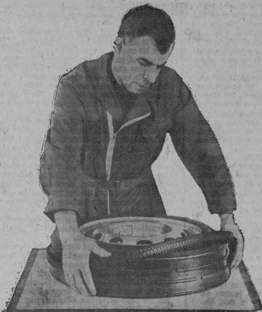
Las bandas se colocan con rapidez y facilidad, sin necesidad de herramientas especiales; se coloca primero la del centro.
